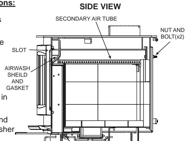
**NOTE: PUSH THE BAFFLE ALL THE WAY TO THE REAR OF THE FIREBOX, LEAVING A MINIMUM OF 1" (25.4mm) GAP ALONG THE FRONT. THIS WILL ALLOW FLUE GASES TO PROPERLY ESCAPE THE FIREBOX.**
