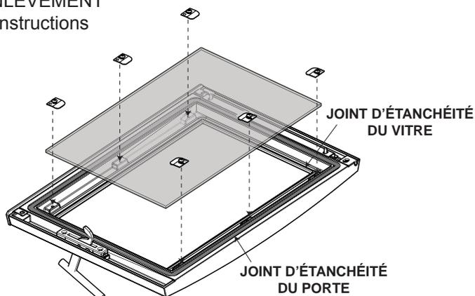
**NOTE:** Pour remplacer la vitre voir la section « RECHANGES ».
