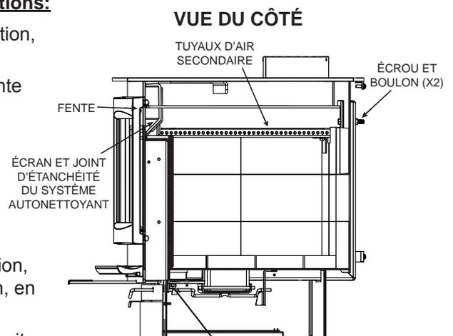
**NOTE:** PUSSEZ LE DÉFLECTEUR ENTIÈREMENT VERS L'ARRIÈRE DE LA CHAMBRE DE COMBUSTION, LAISSANT UN ESPACE MINIMAL DE 1 PO (25,4 MM) À L'AVANT. CECI PERMETTRA AUX FUMÉES DE BIEN ÊTRE ÉVACUÉES DE LA CHAMBRE DE COMBUSTION.
