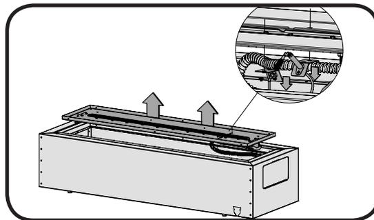
4. Débranchez le raccord flexible en acier inoxydable de l'injecteur à l'aide de deux (2) clés.
