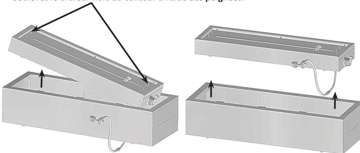
3. L'alimentation en gaz peut entrer par le côté de la base du brûleur ou par le dessous. Pour ce faire, le tuyau doit être débranché de la soupape de gaz et rebranché ensuite par l'autre emplacement. Cette opération doit être effectuée par un installateur qualifié pour le gaz, et le branchement doit être soumis à un test de détection de fuites selon les instructions fournies
