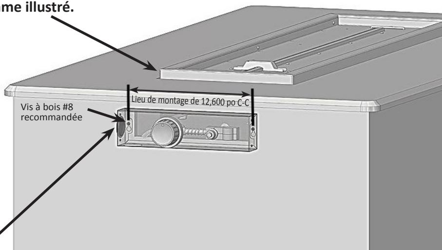
Insérez le bouchon (N510-0012) dans le côté du panneau de commande, comme illustré.
