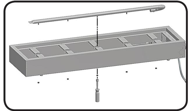
**Réinstallation** : Inversez la procédure pour réinstaller le brûleur. Vérifiez que le l'injecteur entre bien dans le brûleur lors de la réinstallation. Remplacez les braises de verre. Lors de la remise en service de l'appareil, comparez l'apparence de la flamme du brûleur à l'illustration ci-dessous.
