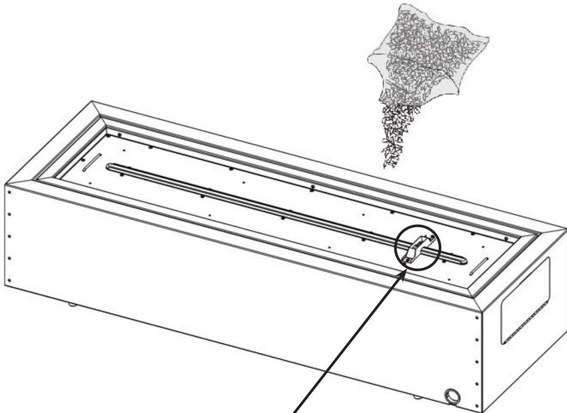
**ENSURE NO GLASS IS PLACED ON THE IGNITION PORTION OF THE BURNER, DIFFICULTIES IN LIGHTING MAY RESULT.**
