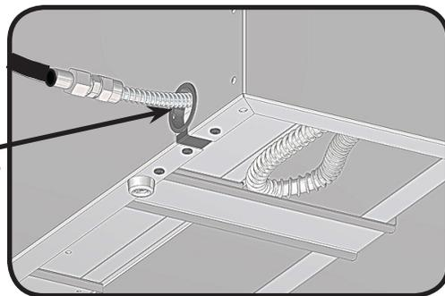
Si l'alimentation en gaz doit passer par le côté du contour, retirez les trois (3) vis de la plaque de recouvrement afin que le trou soit exposé. Insérez la bague dans le panneau de côté pour fixer le tuyau en place. Glissez la plaque de recouvrement par-dessus et réinstallez.
