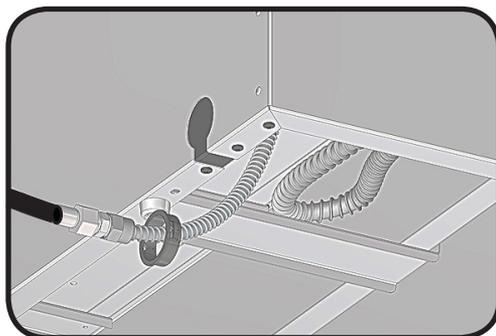
2. Le brûleur peut être utilisé avec ou sans contour. Vous n'avez qu'à le soulever hors du contour pour les séparer. Vous aurez besoin de l'aide d'une personne qui tiendra le tuyau de gaz et le régulateur pour sortir le brûleur du contour. Le brûleur peut être déposé directement sur une surface combustible, mais l'espace de dégagement nécessaire autour et au-dessus du brûleur doit toujours être respecté.
